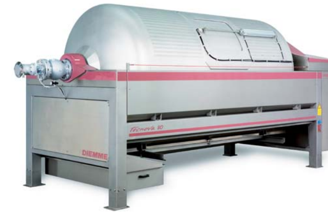
Obr. 4-9: Horizontální pneumatický lis
