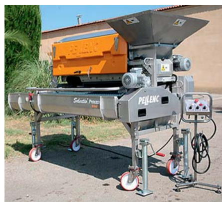
Obr. 2-13: Odstopkovací zařízení SELECTIV PROCESS WINERY
