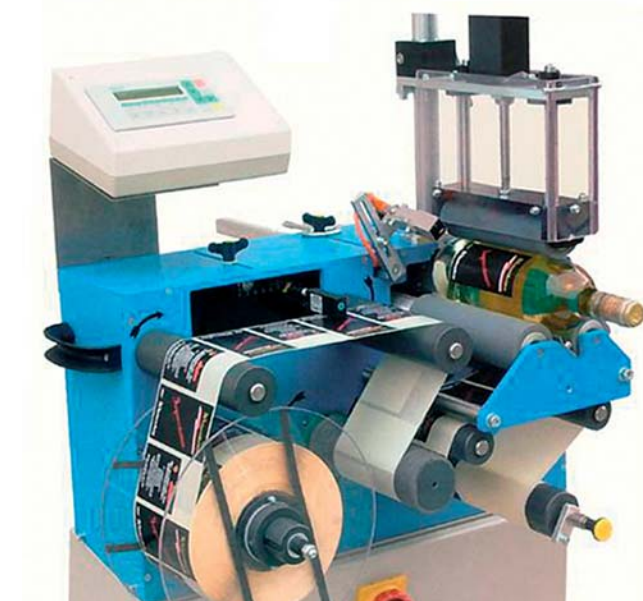
Obr. 13-50: Etiketovací stroj s diskontinuálním způsobem provozu
