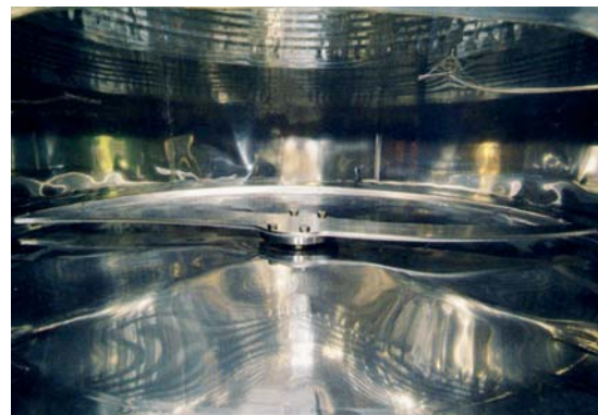
Obr. 6-21: Vrtulový rotor u dna tanku
