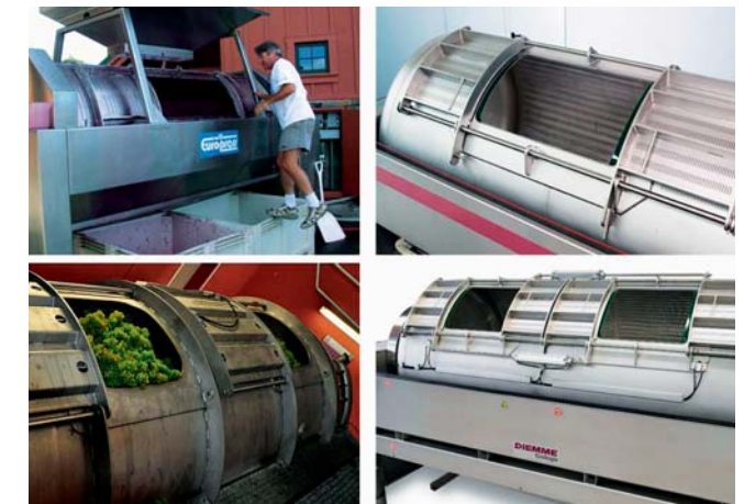
Obr. 4-11: Koše lisů s plnicími otvory
