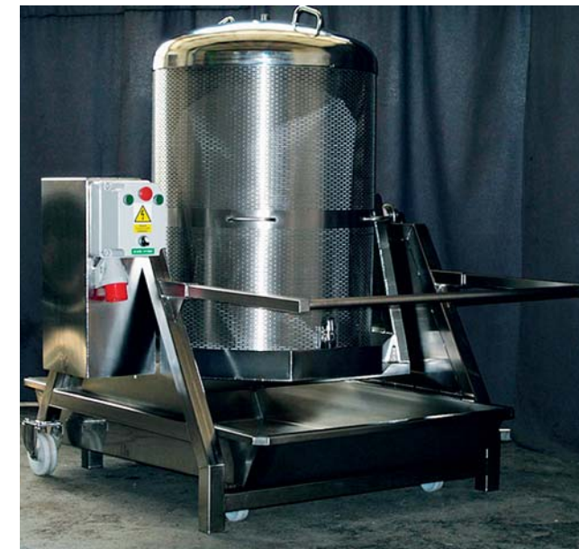
Obr. 4-10: Vertikální pneumatický lis
