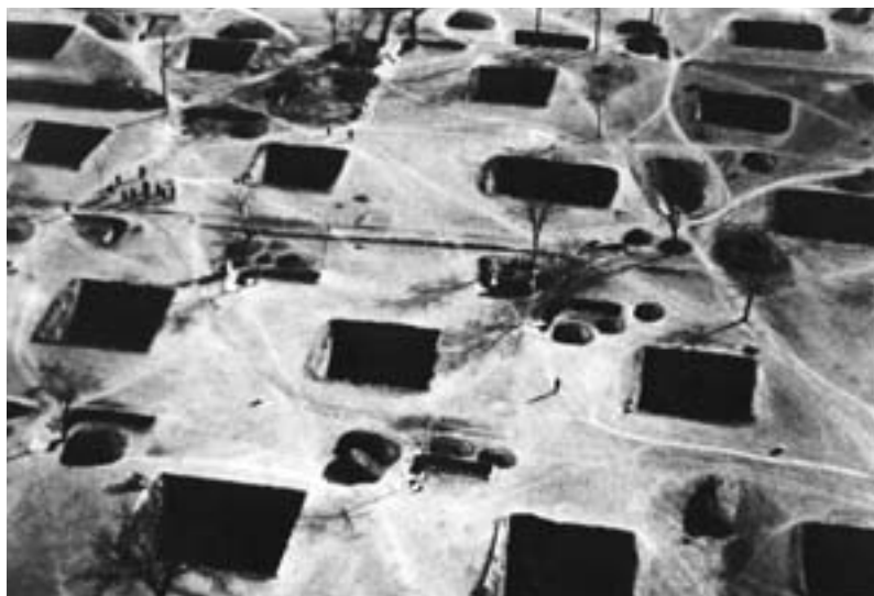
I v současné době se v Číně používají ve sprašových oblastech troglodytická obydlí až devět metrů hluboká, přístupná zvláštním schodištěm.
